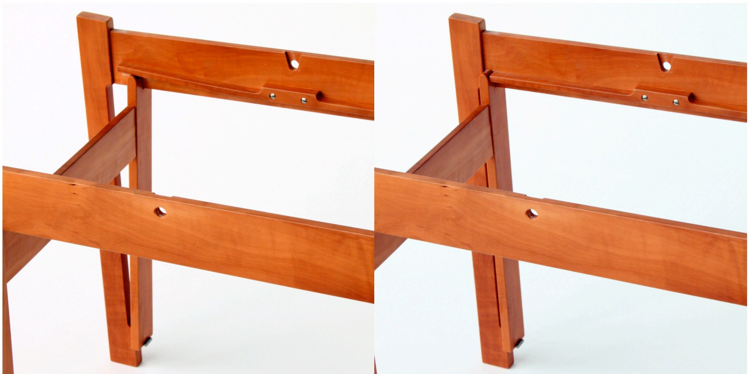
Figur 17. Här syns hur man monterar ramarna till underredet på den mindre taburetten och figur 18 (till höger) visar ramarna i låst läge. Den tunna listen som är fastsatt med två skruvar har precis lagom mycket flex för att först tillåta montering och sedan låsa konstruktionen.
